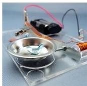
コイルを巻いて作った電磁石をベースにベルを作ります。どのような仕組みでベルが動いているのかを工作を通して学びます。
